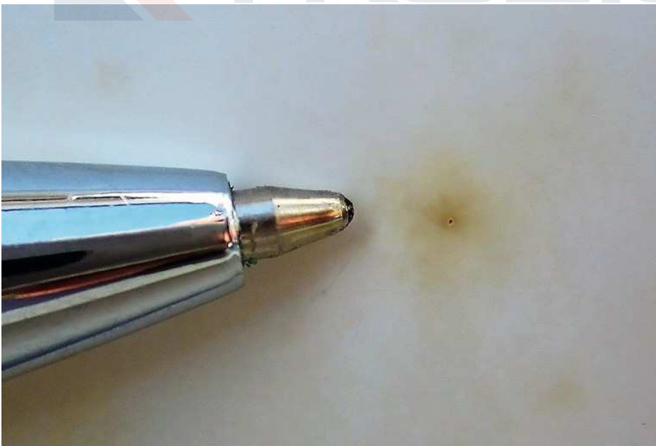
Klein onderdeel, grote impact: Oxiderende metalen splinter omgeven door een gele vlek - ter vergelijking: links een balpenpunt. Foto: Jürgen Sieber
